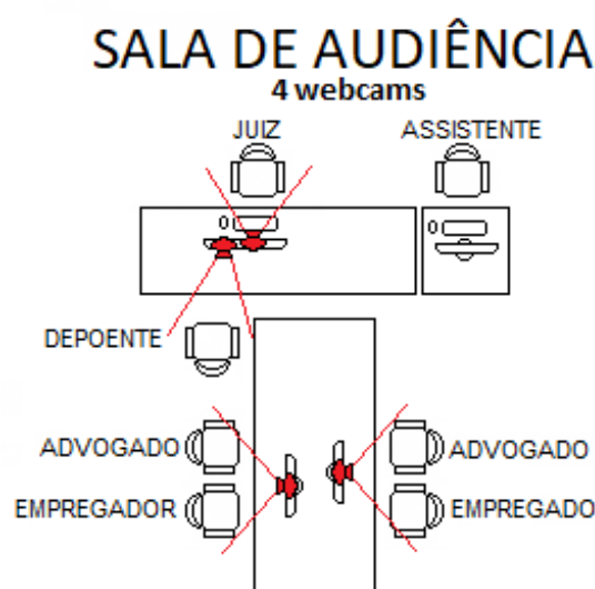
Figura 1 - Esquema de funcionamento da sala de audiências com webcams
