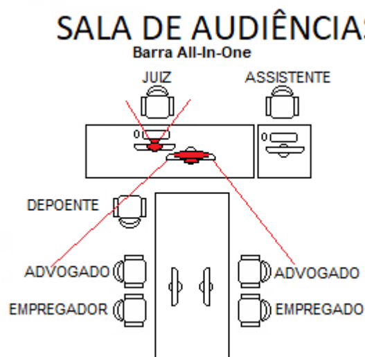
Figura 2 - Esquema de funcionamento da sala de audiências com barra de vídeo USB.
